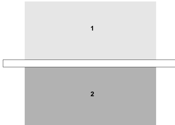
Figura 1.2: Due sistemi termodinamici separati da una parete.
